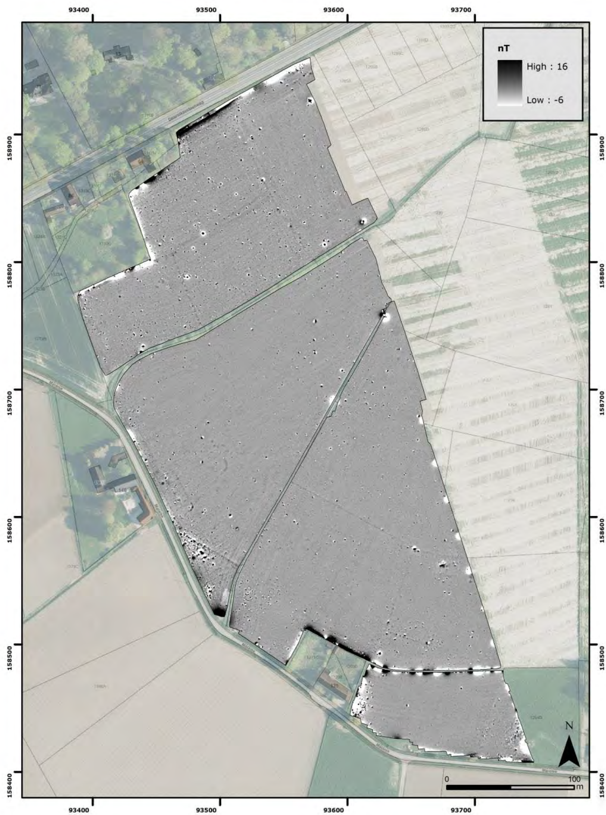
Figuur 61. Magnetische afwijkingen opgemeten met fluxgate magnetometrie (grote meetschaal).©3Dsoil.
