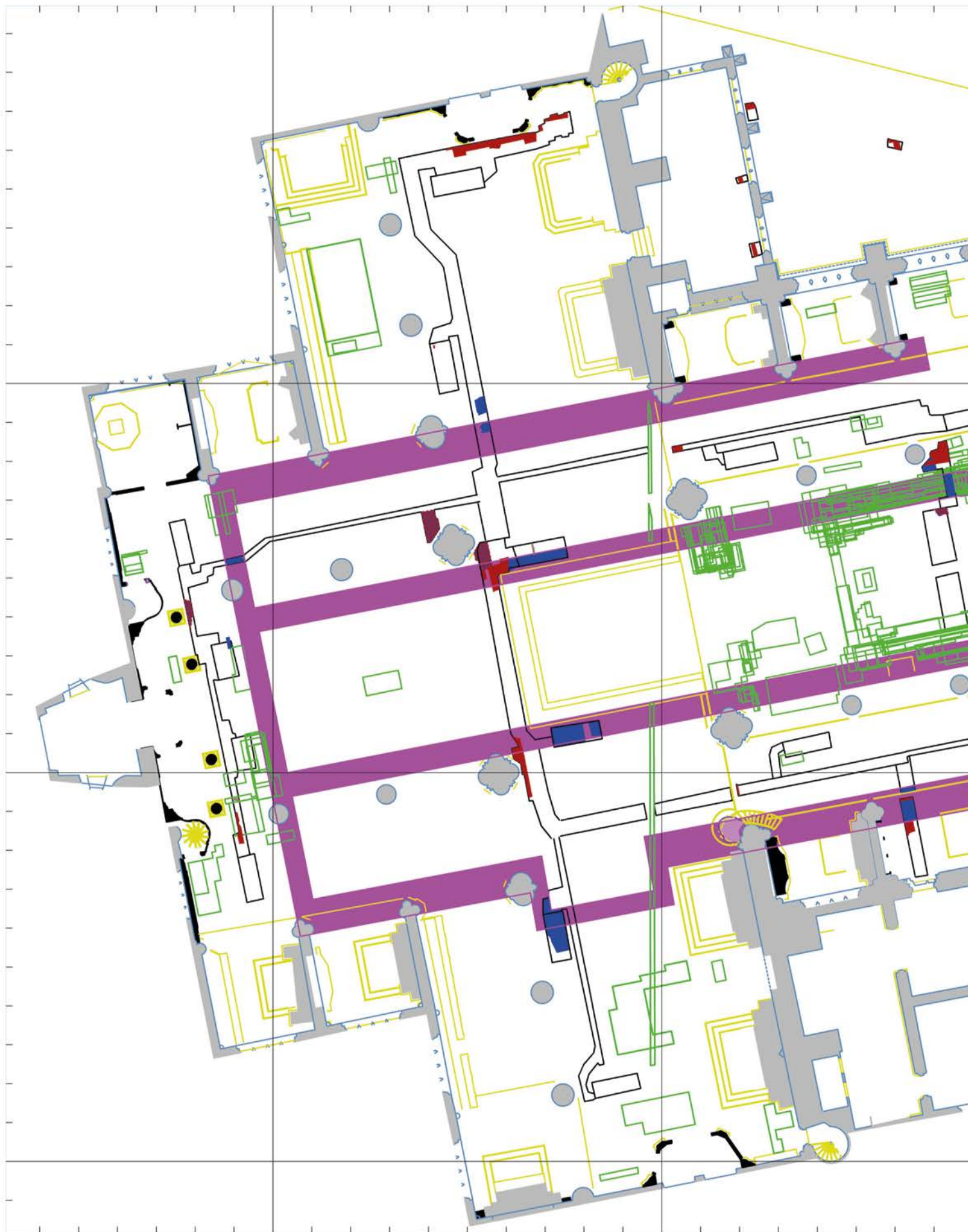
Figuur 155. Hypothetisch grondplan van de Romaanse kerk op basis van de aangetroffen muurmassieven en projectie van het grondradaronderzoek.
