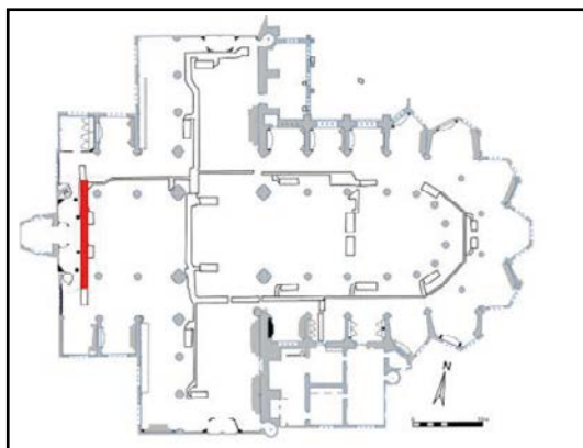
Figuur 130. Situering van de leidingsleuf.
