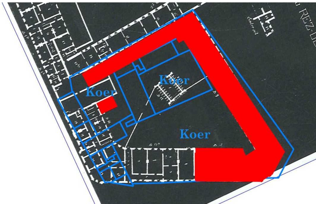
Figuur 25: Grondplan uit ca. 1930 (huidige gebouwencomplex) met daarop een contourenprojectie van een plan van rond 1845, wanneer de oorspronkelijke kloostergebouwen nog bestaan. In rood zijn de bestaande gebouwen aangeduid die zullen afgebroken worden.
