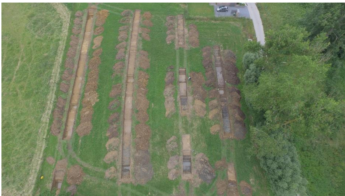
Foto 1: Luchtfoto van het terreinonderzoek. De korte proefsleuven zijn gezet om de verstoring in kaart te brengen. Aan de noordoostkant van het terrein (onderaan op de foto) is de blauwe reductie ten gevolge van recente ophoging en vergraving duidelijk zichtbaar.
