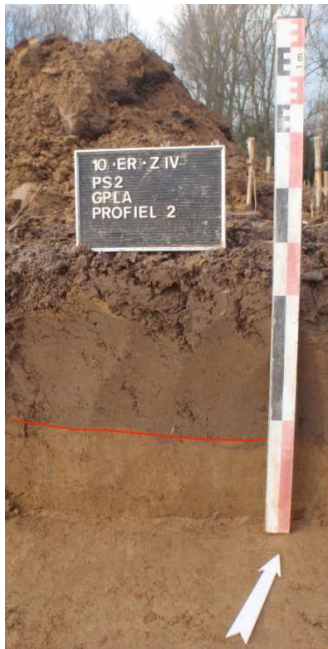
Figuur 1. Bodemprofiel uit zone 1 : ploeglaag, geelbruine leem.
