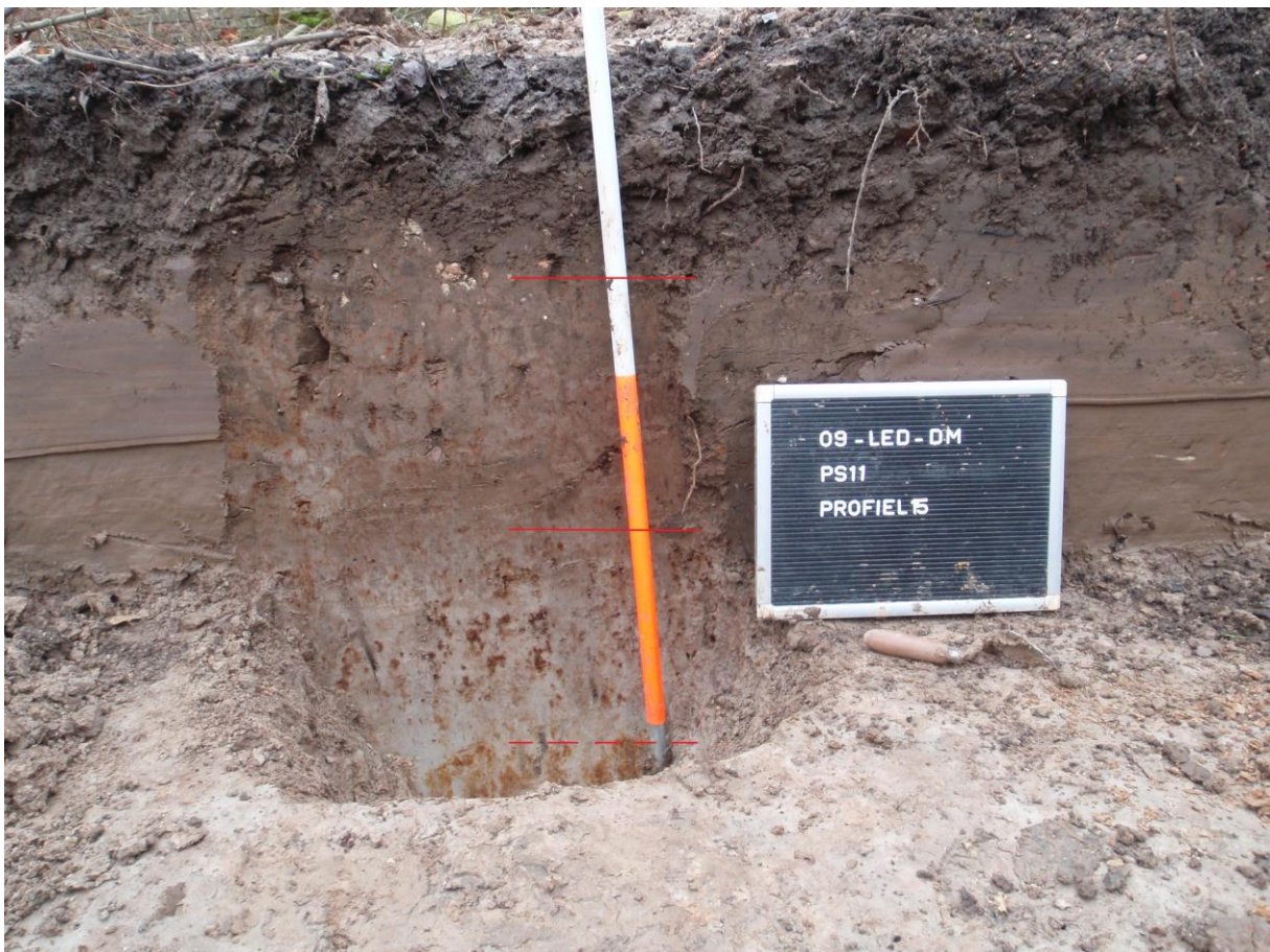
Figuur 3: Profiel 15 in proefsleuf 11 met duidelijke opbouw van de bodem: huidige ploeglaag, oude ploeglaag, colluvium en overgang naar moederbodem
