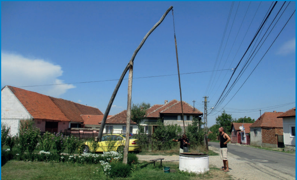
Naast twee van de kleiwinningskuilen zijn twee grote paalsporen uitgegraven in de klei. Deze dienden naar alle waarschijnlijkheid om een hijsstelsel op te stellen zodat men gemakkelijk klei of water uit de kuilen kon tillen. Op de foto is een hedendaags voorbeeld uit Beriu (Roemenië) te zien. © Sadi Maréchal.
