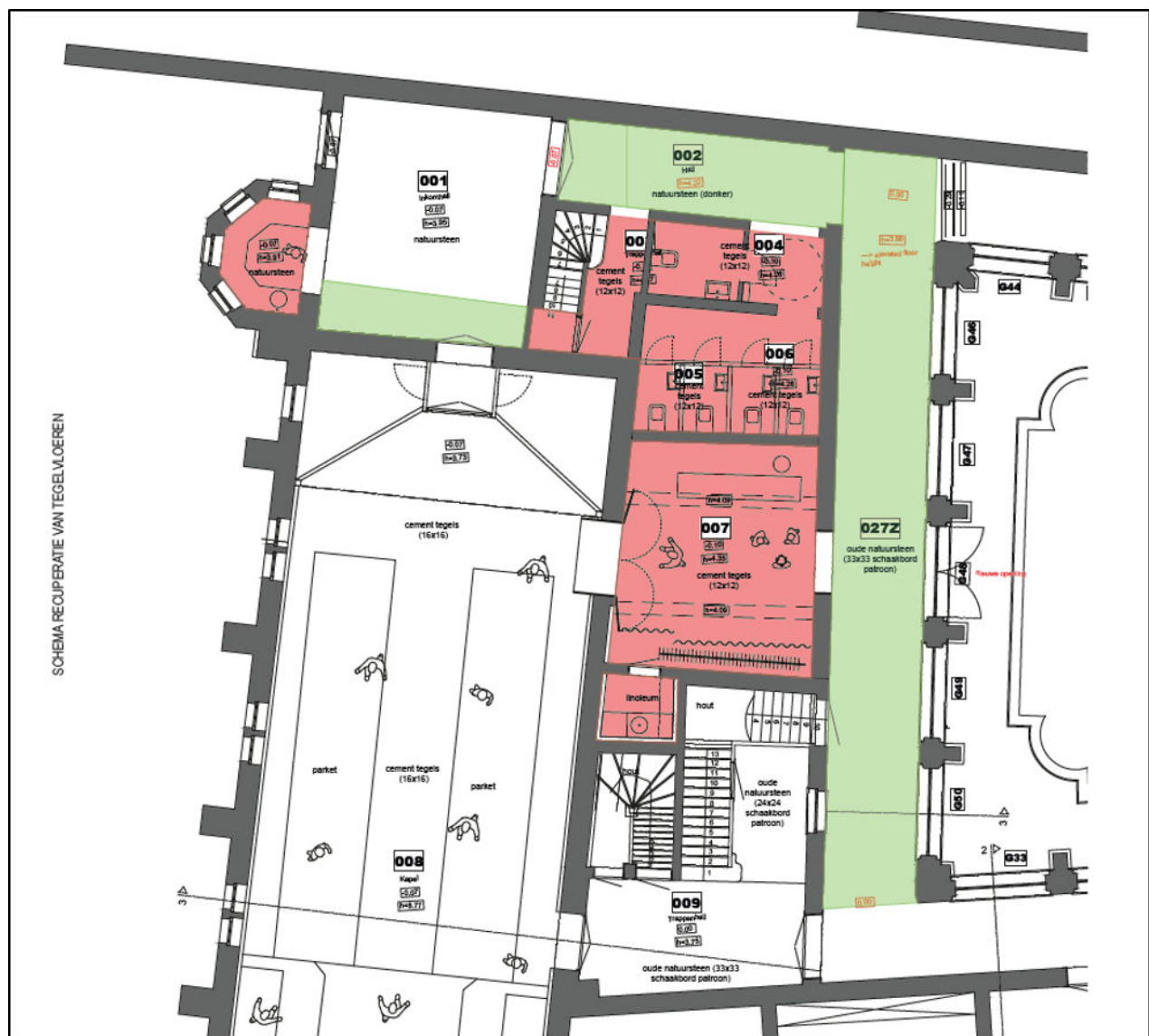
Figuur 6: Overzicht van de zones waar de vloer wordt opgebroken. (rood = vloer niet gerecupereerd, groen = vloer wel gerecupereerd) (bron: Architectenbureau Sabine Okkerse)
