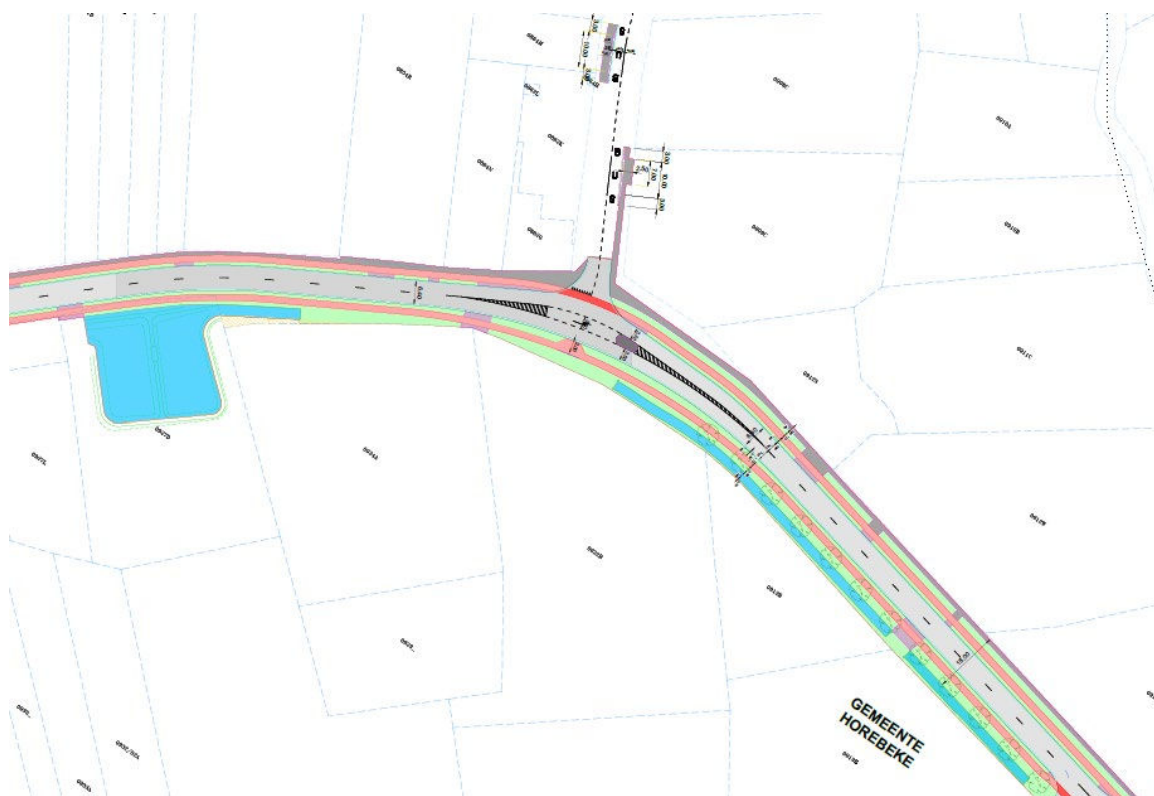
Figuur 10: Uitsnede van Bijlage 5 met weergave van het tweede bufferbekken en de RWA-grachten aan het noordelijk uiteinde van het projectgebied. Langs de Smarre worden vernieuwde bushaltes gepland (© INFRAbureau Demey & Studieburo Goegebeur).
