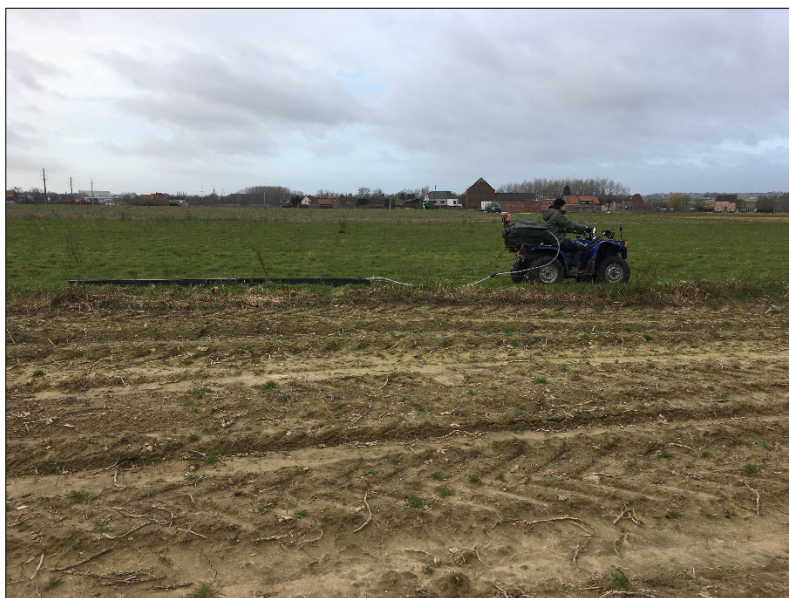
Foto 55 Mobile sensorconfiguratie met de EMI sensor in de slede en RTK-GPS om de metingen te lokaliseren.
