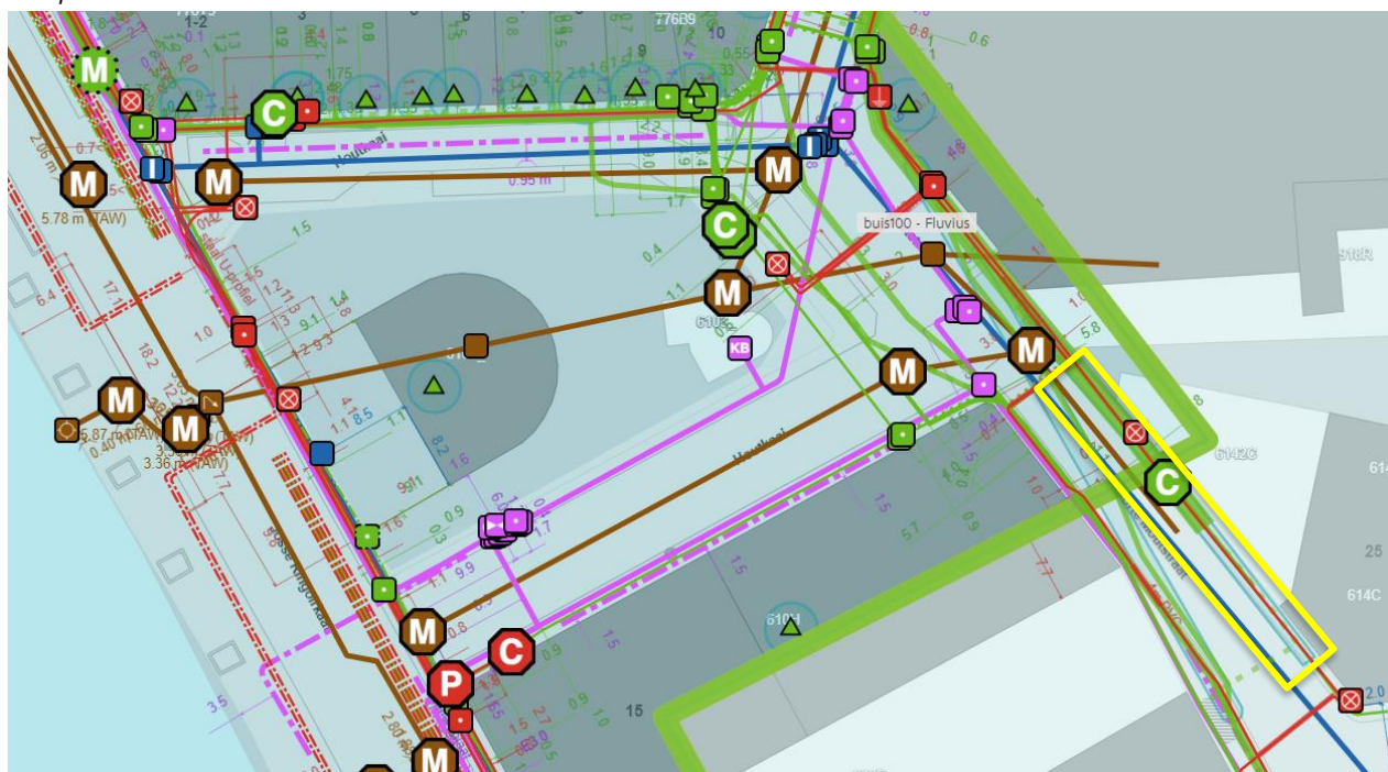
Figuur 32: Klip-plannen met aanduiding van de nutsleidingen ter hoogte van het de Korte Moutstraat (bron: klip.vlaanderen.be & SOLVA)
