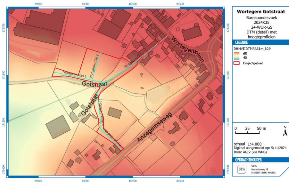
Figuur 13: Het projectgebied op het Digitaal Hoogtemodel van Vlaanderen (detail) met aanduiding van de hoogteprofielen.
