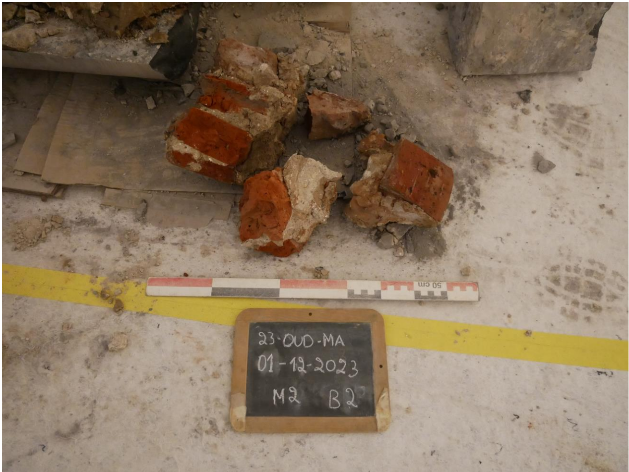
Figuur 14. Boring 2 uit de noordelijke pijler.
