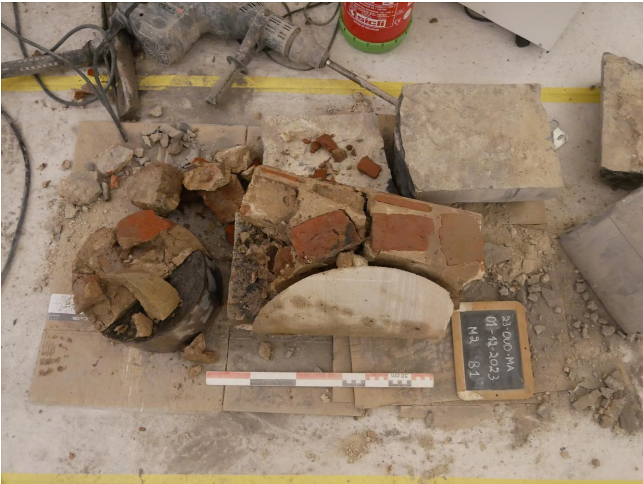
Figuur 13. Boring 1 uit de noordelijke pijler.
