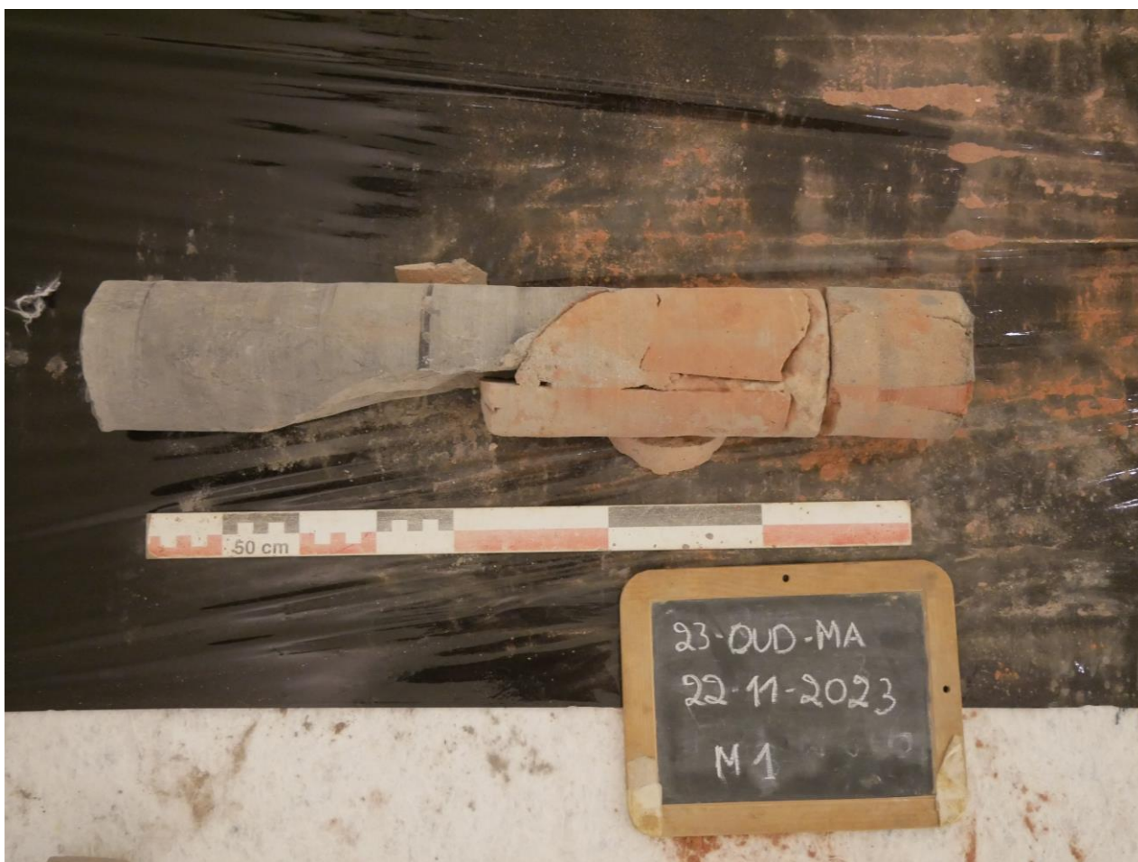
Figuur 3. Detail van boring 1 in de muur van de Benedenlakenhalle.
