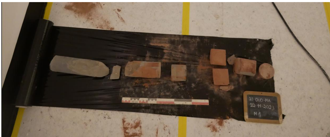
Figuur 2. Boring 1 in de muur van de Benedenlakenhalle (muur 1).
