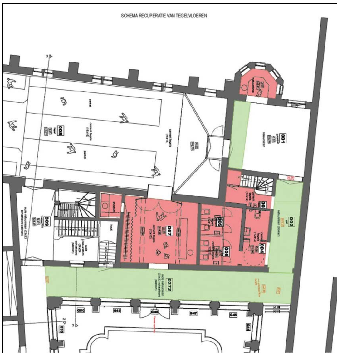
Fig. 6. Overzicht van de zones waar de vloer wordt opgebroken (rood = vloer niet gerecupereerd; groen = vloer wel gerecupereerd) (bron: Architectenbureau Sabine Okkerse).
